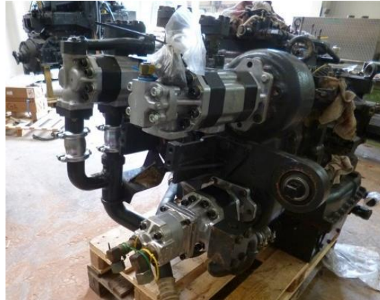
Aufarbeitung des Getriebes und der Hydraulikpumpen der Second-Life Maschine
