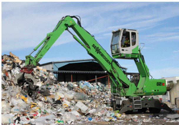
Der 90 kW Elektromotor des Sennebogen 821 E spart bis zu 50% Betriebskosten bei einer täglichen Laufzeit von 8 Arbeitsstunden ein
